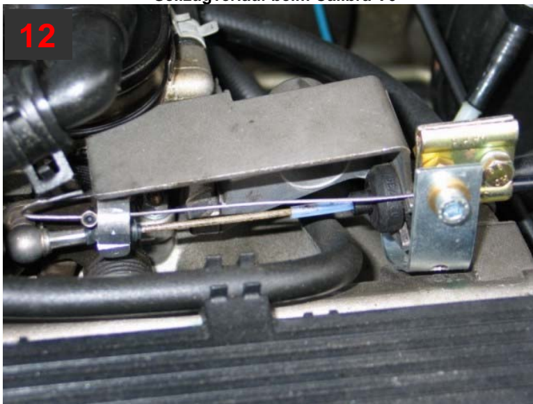
Seilzugbefestigung beim Calibra 16V EcoTec
