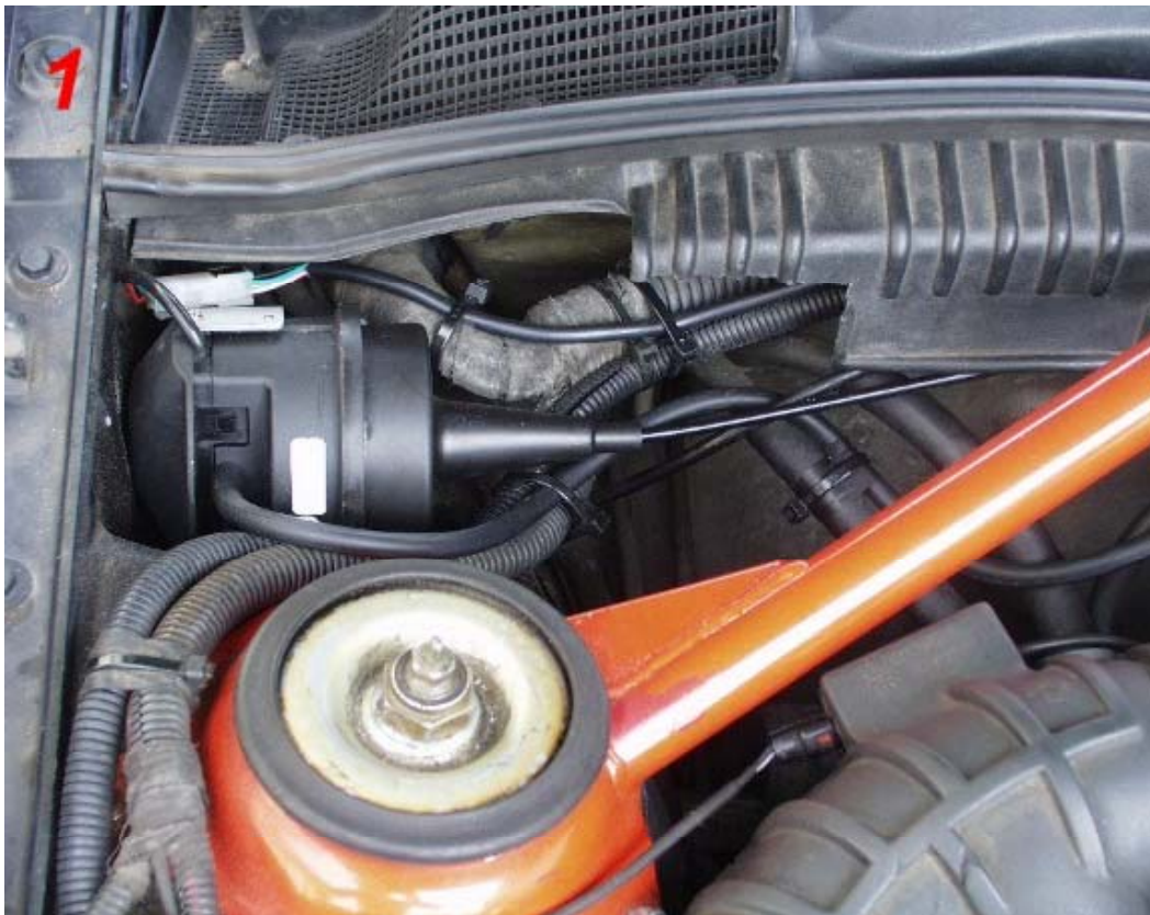
Vakuumpumpe im Motorraum
