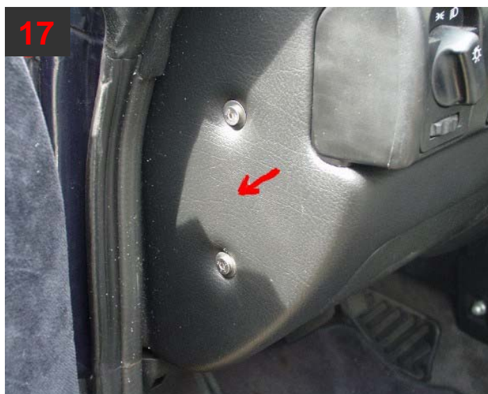
Bild 17 zeigt z.B. eine Befestigungsmöglichkeit des Steuergerätes
