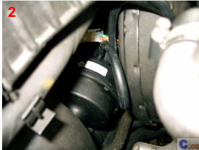
Bild 2 zeigt den Platz wo das Vakuumgerät sitzt. Bei dem vollen Motorraum des LET mit Vollausrüstung ist der einzige Platz neben/hinter dem Bremskraftverstärker. Nicht weit davon entfernt ist ein Loch für die Kabeldurchführung, am 95er LET da wo mal die Tachowelle durchging (elektronischer Tacho) ist ein Blindstopfen.
