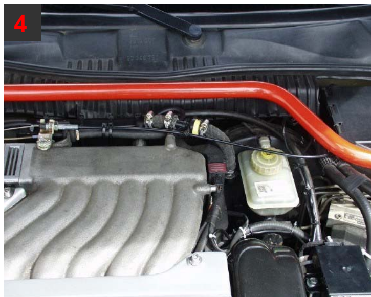
Seilzugführung und Verlauf beim Calibra V6
