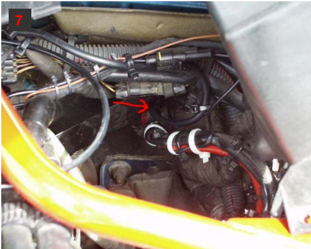
Durchgang des Kabel's in Bild 7 in den Innenraum.
