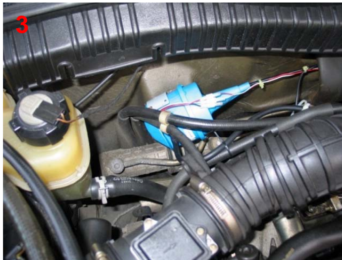
Bild 3: Einbauort der Vakuumpumpe bei einem Calibra 16V EcoTec.
